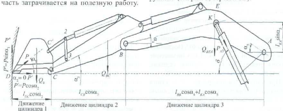
Рис. 3. Схема уточнения плеч конструкции РО на длине AD для составления уравнений моментов
